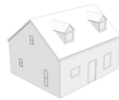
Toit aménagé avec lucarnes
